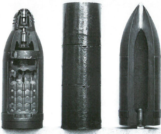
▲ Obus encartouché à balles de la Première Guerre mondiale. En haut, vue de l'obus coupé en deux parties, à droite, la cartouche en laiton contenant la charge propulsive de type cordite. Même vue, à gauche, l'obus lui-même contenant sa charge de balles immobilisées par de la résine. Au centre, la charge explosive, déclenchée par la fusée à temps située à l'extrême gauche, non montée sur l'obus. Vue du bas : l'obus prêt à être utilisé
